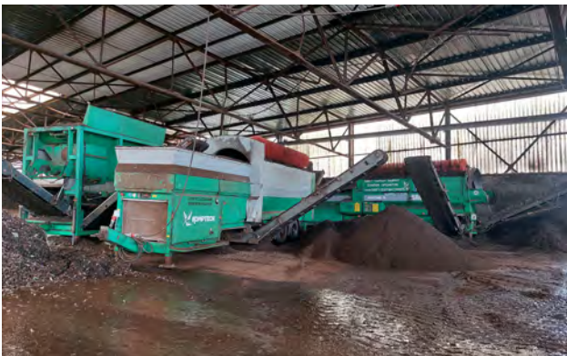
Machine de tamisage pour la fabrication du compost
