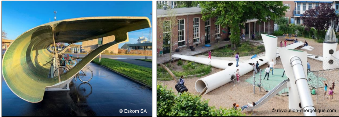
Figure 26 : À gauche : section de pale d'éolienne transformée en garage à vélo (Danemark) ; à droite : sections de mâts et de pales transformées en éléments de plaines de jeux (Pays-Bas).
